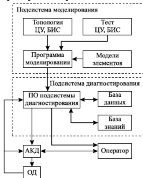
Рис. 6.2. Общая структура экспертной системы диагностирования
