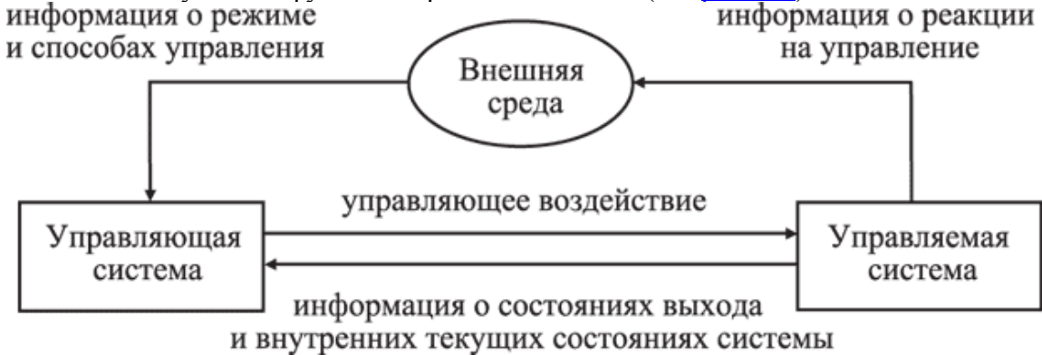
Рис. 7.1. Общая схема управления системой
