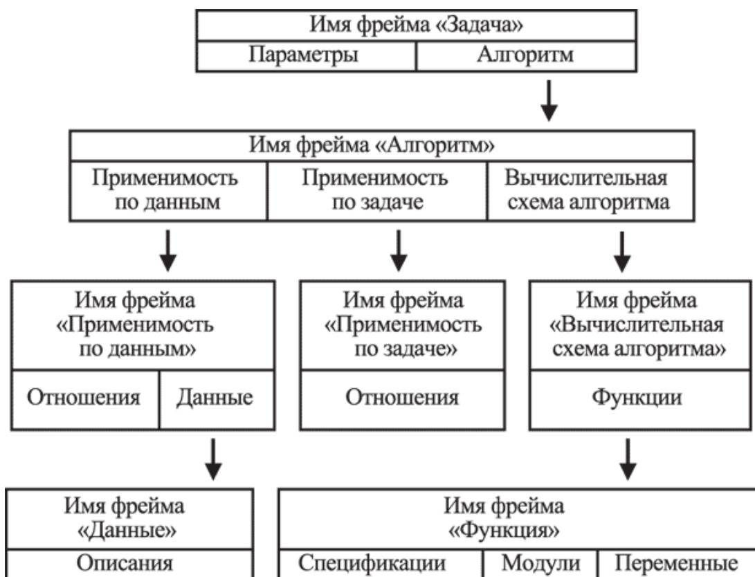
Рис. 14.1. Структура фрейма "Задача вычислительного типа"
